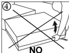
④ Beide nun verbundene Element wieder umdrehen und darauf achten dass der Drehbeschlag keinen Schaden nimmt. **VERBUNDENE ELEMENTE NIEMALS WIE IN FIG. 4 GEZEIGT ANHEBEN.**
