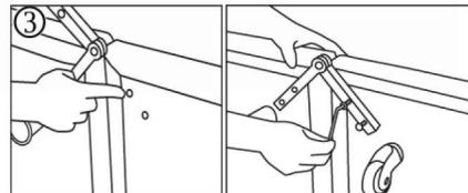
③ Nun auch das 2. Element auf den Kopf drehen und den Drehbeschlag auch dort mit den 2 Imbusschrauben befestigen.
