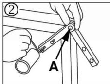
② Drehbeschlag mit den 2 Schrauben mit Hilfe eines Imbusschlüssels fest-ziehen wobei die Schraube "A" des Drehbeschlags nach unten zeigen soll.
